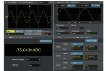
1ベンチの複数計測器の同時モニタ例
